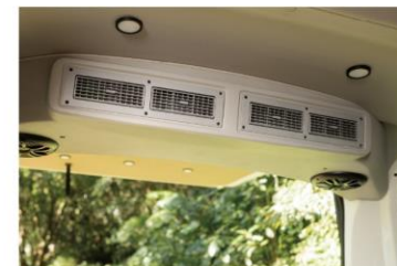
直流變頻駐車空調系統
